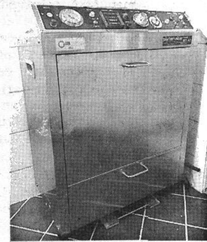
Kemigrafias platemaskin for polymerklisjeer opp til format A3. Denne maskinen er forsatt i daglig drift.
