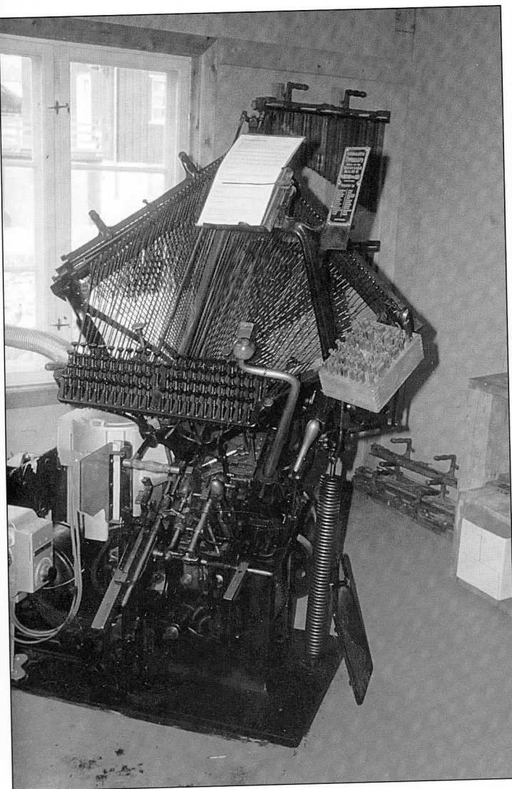
Typograph settemaskin, nå i driftsklar stand, men mangler et skriftsmagasin.
