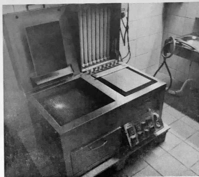
Klisjemaskinen som benyttes til å lage trykk-klare plater består av to enheter, en til belysning og en til utvasking av klisjeene
