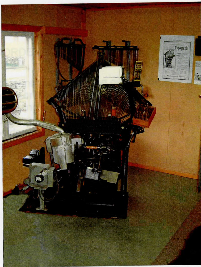
Typograph settemaskin No. 7002 Mod. B fra Gebaut von Typograph GmbH, Berlin.
