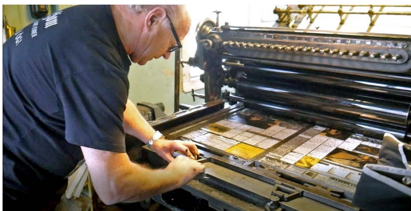
Jens Hystad, aktivt dugnadsmedlem i mer enn 30 år, monterer sideformene i trykkpressa.
