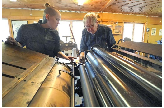
Fra dugnaden høsten 2023. Maria og Bjørn-Erik arbeider på flattrykkpressa fra Lillesandsposten. Med nye valser og etter mange dugnadstimer er den nå operativ igjen.
